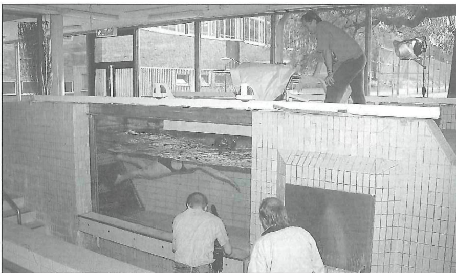
Simrännan med strömmande vatten som ger möjlighet att öka till världsrekordfart på 100 m fritt. Ger möjlighet att samtidigt studera både biomekanik och energiomsättning. Foto Artur Forsberg.
