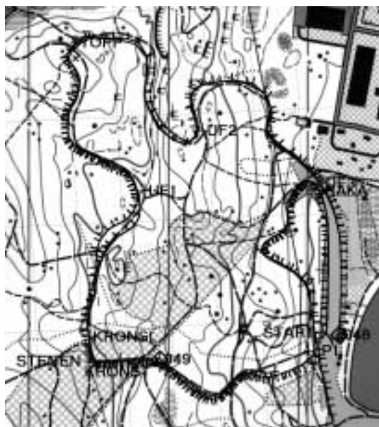
Bild 3. Differentierad GPS data från två varv av längdskidåkning, lagd ovanpå en skannad karta i GPS programvara (GPS utility). De små sträckor markerar en positionsangivelse (En position var annan sekund).
