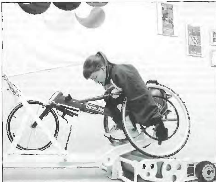
RIG-eleven Veronica Braun under test på en specialbyggd, datorstyrd, rulle för rullstolsåknings tester och -träning.
